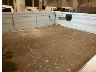
Döşemeler/Kapaklar, Döşemeler/Kapaklar > Çizik
