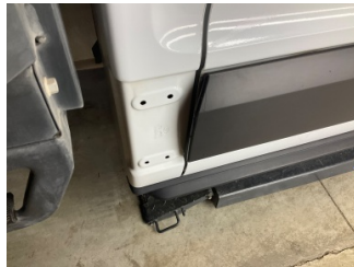
Kapı, sağ arka, Kapı bandı > Eksik
