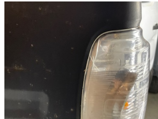
Dikiz aynası, sol, Sinyal lambası > Çatlak
