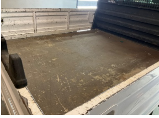
Döşemeler/Kapaklar, Bagaj kapağı, iç döşemesi > Boyası Atmış
