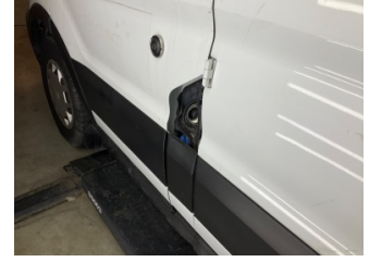
Çamurluk, sol arka, Yakıt deposu kapağı > Sökülmüş-Yok
