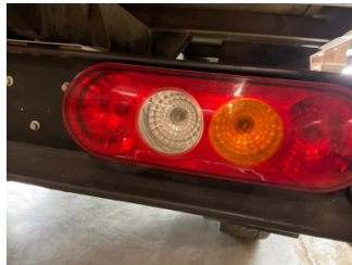
Arka lambalar, Arka lambalar, sağ > Hasarlı
