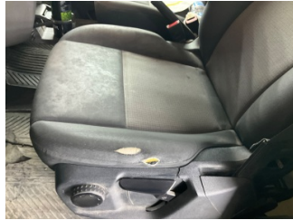
Döşemeler/Kapaklar, Döşemeler/Kapaklar > Hasarlı
