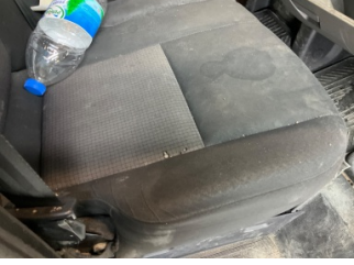
Döşemeler/Kapaklar, Döşemeler/Kapaklar > Hasarlı
