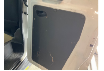
Döşemeler/Kapaklar, Döşemeler/Kapaklar > Deforme Olmuş
