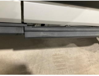
Marşbiyel, sağ, Marşbiyel plastiği, sağ > Sabitlemesi Hatalı
