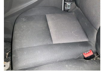
Döşemeler/Kapaklar, Döşemeler/Kapaklar > Yakıcı Madde ile Zarar Görmüş
