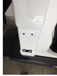
Kapı, sağ arka, Kapı bandı > Sökülmüş-Yok
