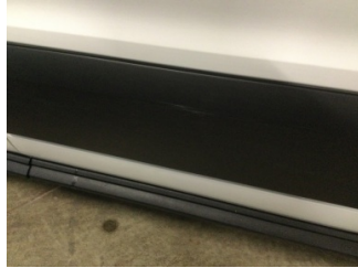
Kapı, sol ön, Kapı bandı > Çizik
