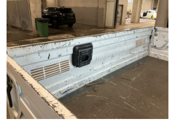
Bagaj kapağı/kapısı, Bagaj kapısı > Boyası Atmış
