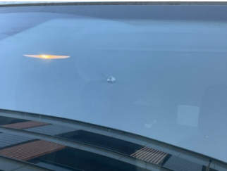
Camlar, Ön cam > Çatlak
