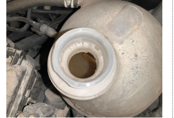
Motorsoğutması, Soğutma sıvısı > Eksik
