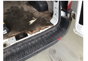
Döşemeler/Kapaklar, Bagaj bölümü döşemesi > Hasarlı
