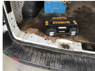
Döşemeler/Kapaklar, Bagaj bölümü döşemesi > Hasarlı
