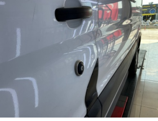
Kapı, sol ön, Kapı, sol ön > Ezik
