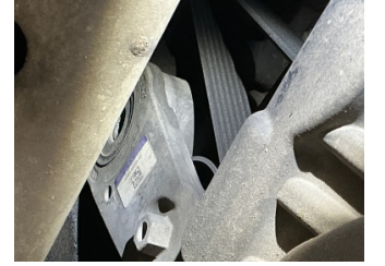
Motorsoğutması, Kayış > Deforme Olmuş
