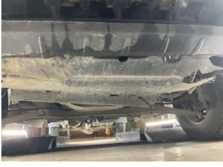
Motor, Alt muhafaza > Hasarlı
