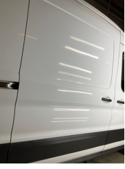
Kapı, sağ arka, Kapı, sağ arka > Ezik
