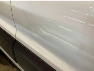
Kapı, sağ arka, Kapı, sağ arka > Ezik
