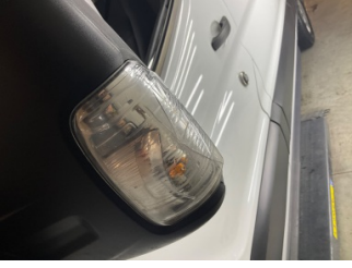
Dikiz aynası, sol, Sinyal lambası > Çatlak
