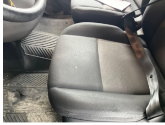
Döşemeler/Kapaklar, Döşemeler/Kapaklar > Yakıcı Madde ile Zarar Görmüş
