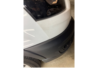
Tampon, ön, Ön tampon > Sabitlemesi Hatalı
