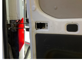
Döşemeler/Kapaklar, Bagaj kapağı, iç döşemesi > Eksik
