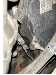
Motor, Triger zinciri kapağı > Yağ Kaçağı
