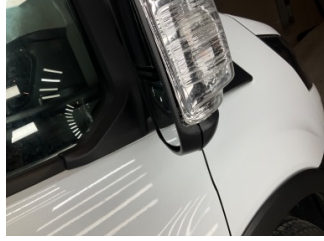
Dikiz aynası, sağ, Sinyal lambası > Sabitlemesi Hatalı
