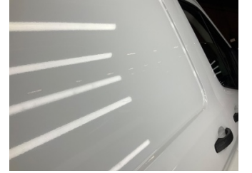
Kapı, sağ arka, Kapı, sağ arka > Çizik
