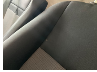
Döşemeler/Kapaklar, Döşemeler/Kapaklar > Yakıcı Madde ile Zarar Görmüş
