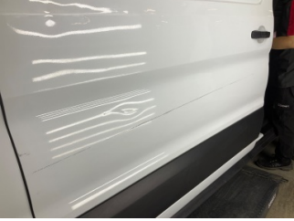
Kapı, sağ arka, Kapı, sağ arka > Çizik
