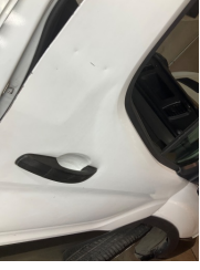
Kapı, sağ ön, Kapı, sağ > Ezik
