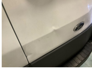
Bagaj kapağı/kapısı, Bagaj kapısı, sağ > Hasarlı
