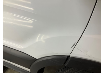
Kapı, sağ ön, Kapı, sağ ön > Çizik
