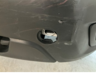
Tampon, ön, Çeki demir kapağı > Sökülmüş-Yok
