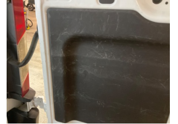
Döşemeler/Kapaklar, Döşemeler/Kapaklar > Hasarlı
