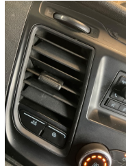
Kalorifer/Klima, Havalandırma ızgarası > Hasarlı
