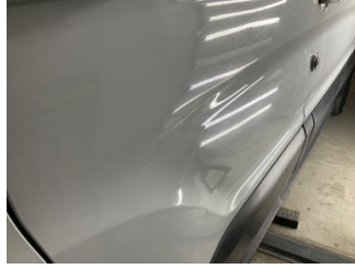
Kapı, sol ön, Kapı, sol ön > Ezik
