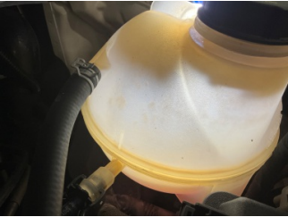
Motorsoğutması, Soğutma sıvısı > Eksik
