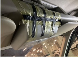
Elektrik donanımı/Pano, iç aydınlatma, ön > Sabitlemesi Hatalı
