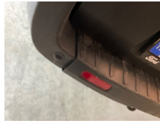
Tampon, arka, Arka tampon > Sabitlemesi Hatalı
