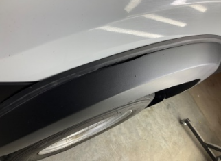
Çamurluk, sol arka, Nikelaj > Hasarlı
