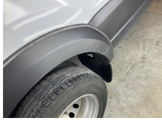
Çamurluk, sol arka, Nikelaj > Hasarlı
