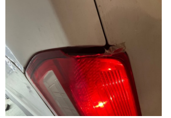
Arka lambalar, Arka lamba camı, sol > Hasarlı
