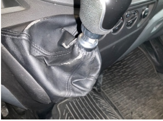
Şanzıman, Vites körüğü > Deforme Olmuş
