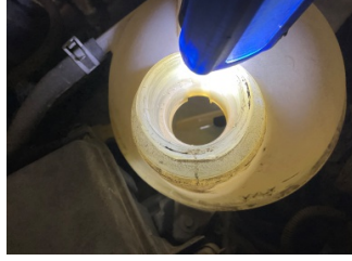
Motorsoğutması, Soğutma sıvısı > Eksik
