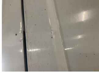
Bagaj kapağı/kapısı, Bagaj kapısı > Ezik
