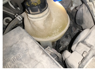
Motorsoğutması, Soğutma sıvısı > Eksik
