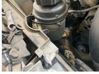
Direksiyon sistemi, Hidrolik yağı kabı > Sabitlemesi Hatalı
