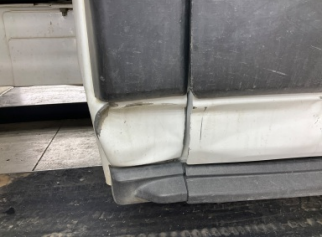
Kaporta, B-direk, sağ > Hasarlı
