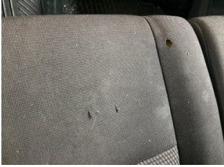
Döşemeler/Kapaklar, Döşemeler/Kapaklar > Yakıcı Madde ile Zarar Görmüş
