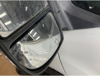
Dikiz aynası, sol, Dış dikiz aynası > Hasarlı
