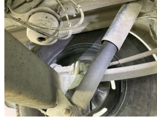
Arka aks, Amortisör, arka sol > Yağ Kaçağı
