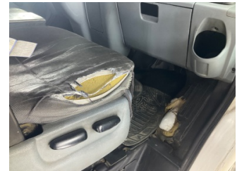
Döşemeler/Kapaklar, Döşemeler/Kapaklar > Hasarlı
