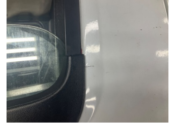
Kapı, sol ön, Kapı, sol ön > Çatlak
