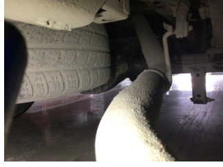
Arka aks, Diferansiyel kapağı > Yağ Kaçağı
