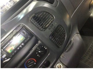
Kalorifer/Klima, Havalandırma ızgarası > Standart Dışı Onarım
