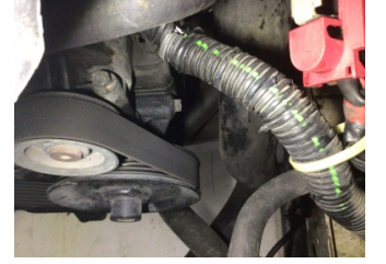
Direksiyon sistemi, Hidrolik pompası > Yağ Kaçağı
