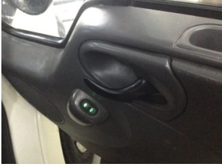
Kapı, sağ ön, Kapı kolu, iç > Sabitlemesi Hatalı
