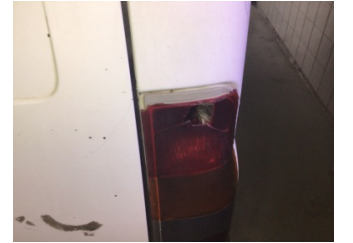
Arka lambalar, Arka lambalar, sağ > Hasarlı
