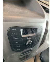
Komünikasyon/Navigasyon/Eğlence sistemleri, Radyo, CD, DVD > Çatlak
