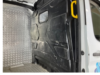
Döşemeler/Kapaklar, Bagaj bölümü döşemesi > Ezik
