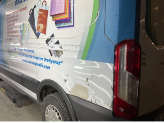
Çamurluk, sol arka, Çamurluk, sol arka > Hasarlı
