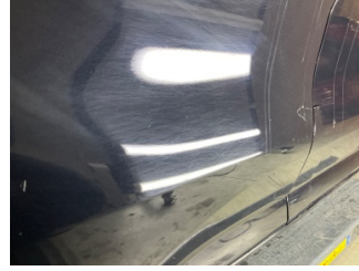
Kapı, sol ön, Kapı, sol ön > Çizik
