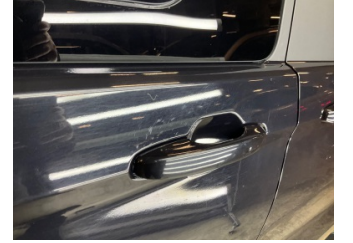
Kapı, sağ arka, Kapı, sağ arka > Çizik
