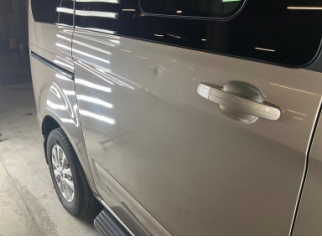
Kapı, sağ arka, Kapı, sağ arka > Ezik
