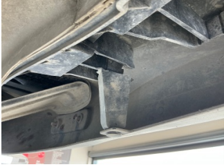
Tampon, arka, Bağlantı ayağı > Hasarlı
