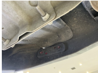
Tampon, arka, Bağlantı ayağı > Hasarlı
