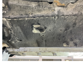
Motor, Alt muhafaza > Deforme Olmuş
