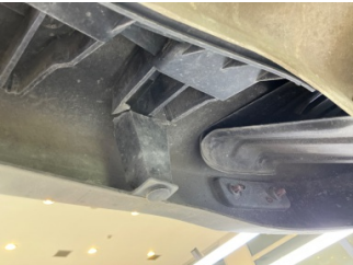
Tampon, arka, Bağlantı ayağı > Hasarlı
