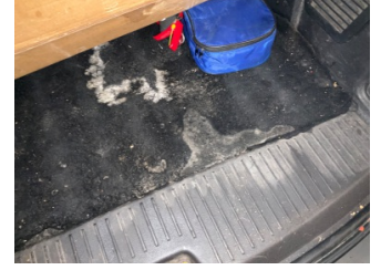
Döşemeler/Kapaklar, Bagaj kapağı, iç döşemesi > Yakıcı Madde Ile Zarar Görmüş
