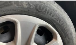
Lastik, sağ arka > Deforme Olmuş
