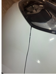
Tampon, ön, Ön tampon > Sabitlemesi Hatalı
