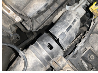
Motor, Hava filtresi kabı > Hasarlı
