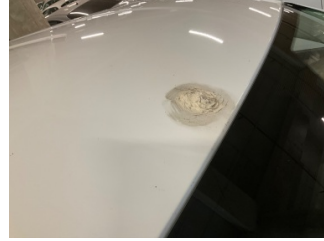
Komünikasyon/Navigasyon/EğlenceTavan, Tavan > Standart Dışı sistemleri, Anten > Sökülmüş-Yok Onarım
