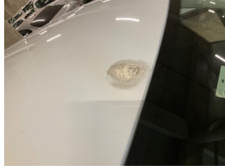
Komünikasyon/Navigasyon/EğlenceTavan, Tavan > Standart Dışı sistemleri, Anten > Sökülmüş-Yok Onarım
