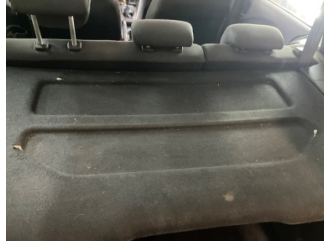
Döşemeler/Kapaklar, Pandizot > Deforme Olmuş
