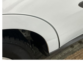
Çamurluk, sağ arka, Çamurluk, sağ arka > Ezik
