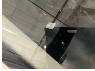
Camlar, Ön cam > Çatlak
