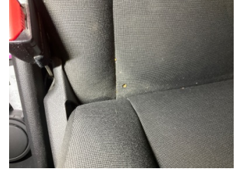
Döşemeler/Kapaklar, Döşemeler/Kapaklar > Yakıcı Madde ile Zarar Görmüş
