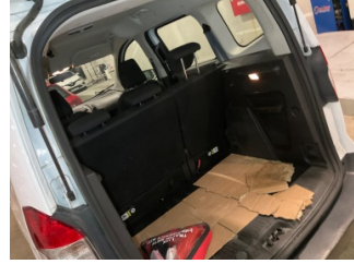
Döşemeler/Kapaklar, Pandizot > Sökülmüş-Yok
