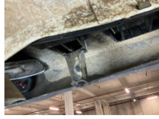
Tampon, arka, Bağlantı ayağı > Hasarlı
