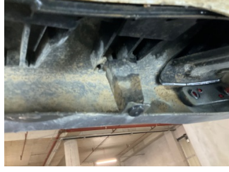
Tampon, arka, Bağlantı ayağı > Hasarlı
