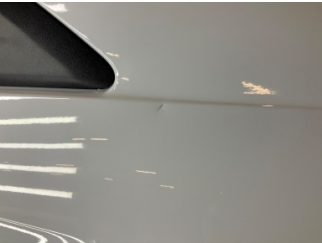
Çamurluk, sağ, Çamurluk, sağ > Ezik
