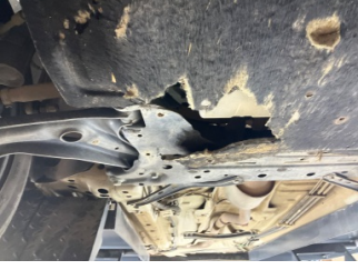
Motor, Alt muhafaza > Hasarlı
