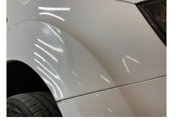
Çamurluk, sağ, Çamurluk, sağ > Taş Izi
