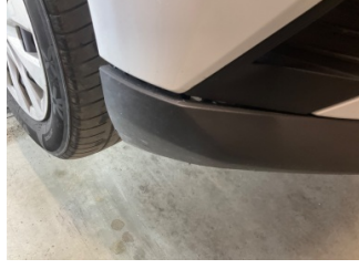
Tampon, ön, Spoiler > Sabitlemesi Hatalı
