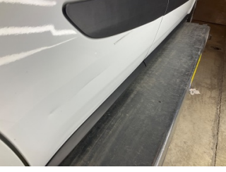
Kapı, sağ arka, Kapı, sağ arka > Ezik
