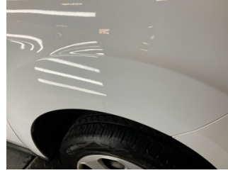
Çamurluk, sağ, Çamurluk, sağ > Taş izi
