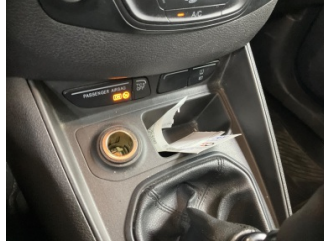
Elektrik donanımı/Pano, Çakmak > Sökülmüş-Yok
