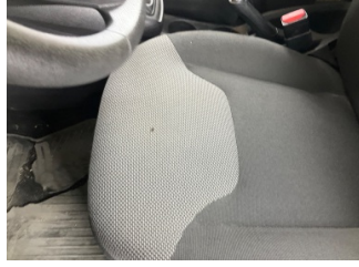
Döşemeler/Kapaklar, Döşemeler/Kapaklar > Yakıcı Madde ile Zarar Görmüş
