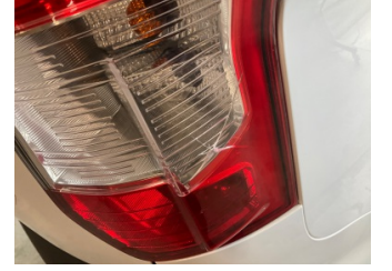
Arka lambalar, Arka lamba camı, sağ > Çatlak
