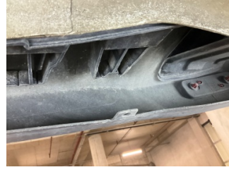
Tampon, arka, Bağlantı ayağı > Hasarlı
