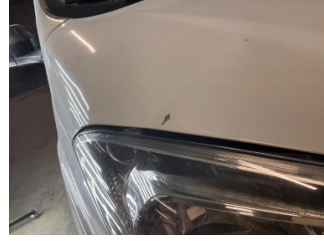
Motor kaputu, Motor kaputu > Hasarlı
