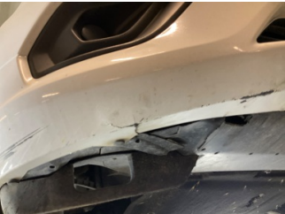
Tampon, ön, Ön tampon > Kırılmış
