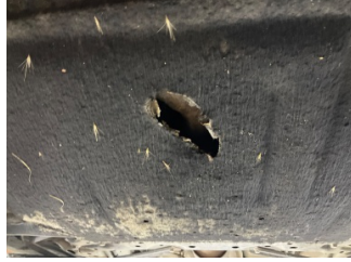
Motor, Alt muhafaza > Hasarlı
