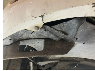
Tampon, ön, Tampon koruyucu orta > Hasarlı
