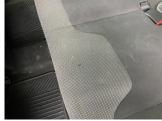
Döşemeler/Kapaklar, Döşemeler/Kapaklar > Yakıcı Madde ile Zarar Görmüş
