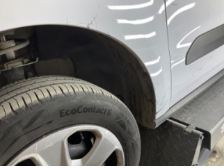
Çamurluk, sol, Çamurluk, sol > Deforme Olmuş
