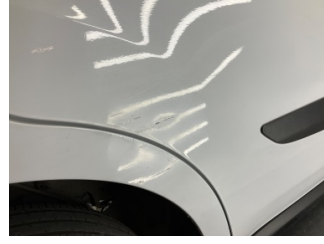
Kapı, sağ arka, Kapı, sağ arka > Ezik
