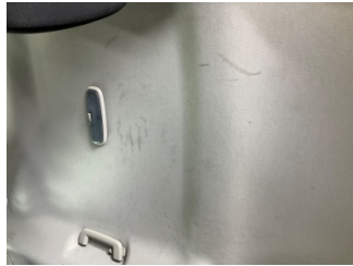
Döşemeler/Kapaklar, Tavan döşemesi > Kirlenmiş
