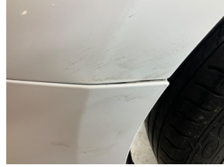
Tampon, arka, Arka tampon > Sabitlemesi Hatalı
