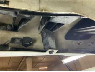
Tampon, arka, Bağlantı ayağı > Hasarlı
