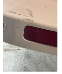
Tampon, arka, Reflektör, sağ > Kırılmış
