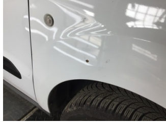
Çamurluk, sağ, Çamurluk, sağ > Pas
