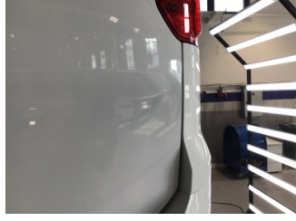
Bagaj kapağı/kapısı, Bagaj kapısı > Ezik
