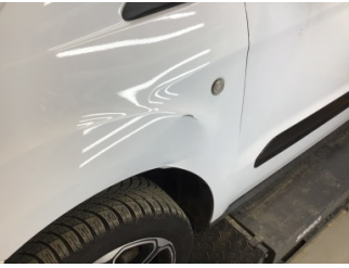
Çamurluk, sol, Çamurluk, sol > Hasarlı
